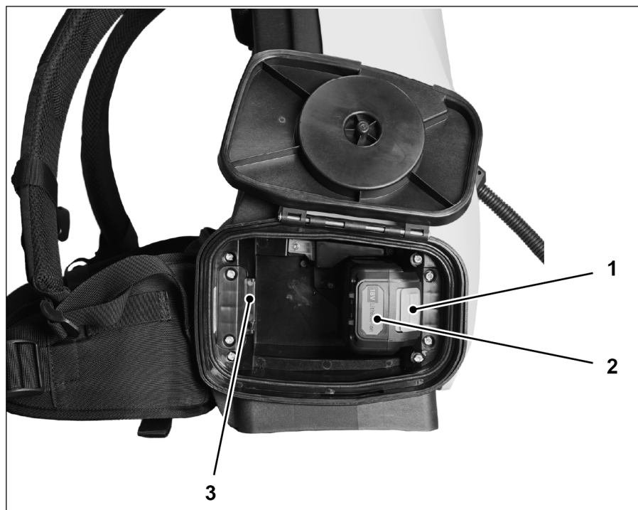
Abb. 5 Otwarta komora akumulatora
